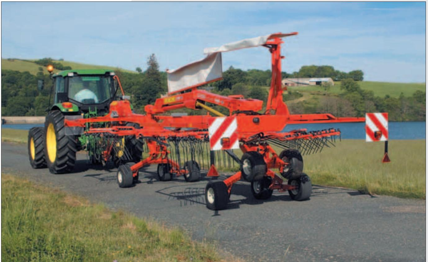
Die Umstellung in Transportposition erfolgt von der Traktorkabine aus.
