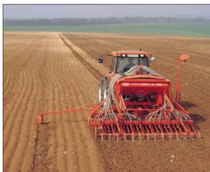
Pneumatische Drillmaschinen mit Arbeitsbreiten von 3 bis 6 m (als Aufbaumaschinen).
