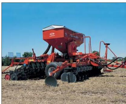
Direktsaat-Drillmaschinen mit Arbeitsbreiten von 3 bis 6 m mit mechanischer oder pneumatischer Verteilung.
