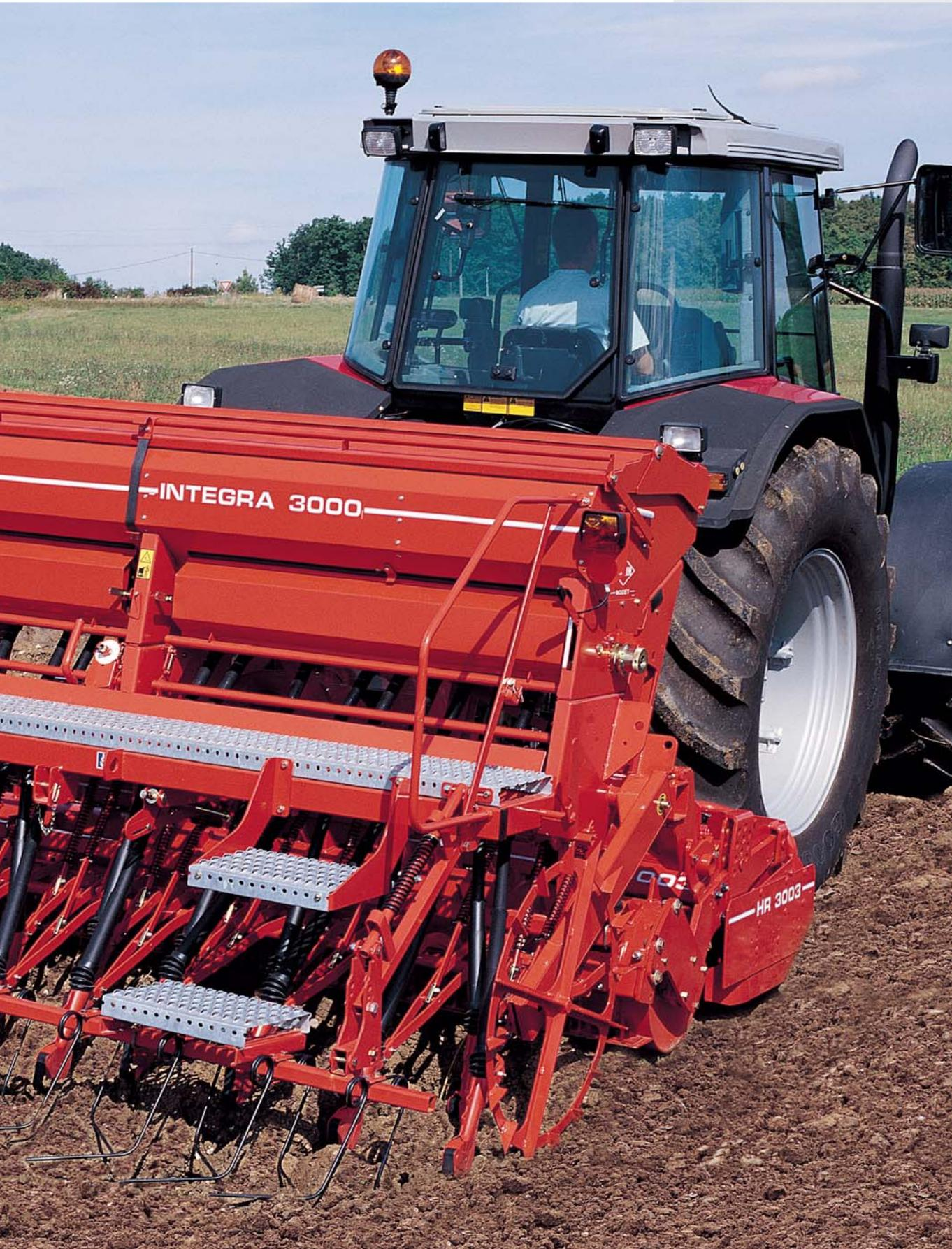
DRILLMASCHINE INTEGRA 3000
