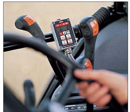
Die Kontroll- und Bedienungseinheit HECTOR 3000 hat folgende wichtige Funktionen zur Überwachung der Drillmaschine:
