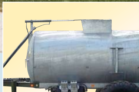
Hydraulischer Schubdeckel, 700 mm x 700 mm Öffnung.
