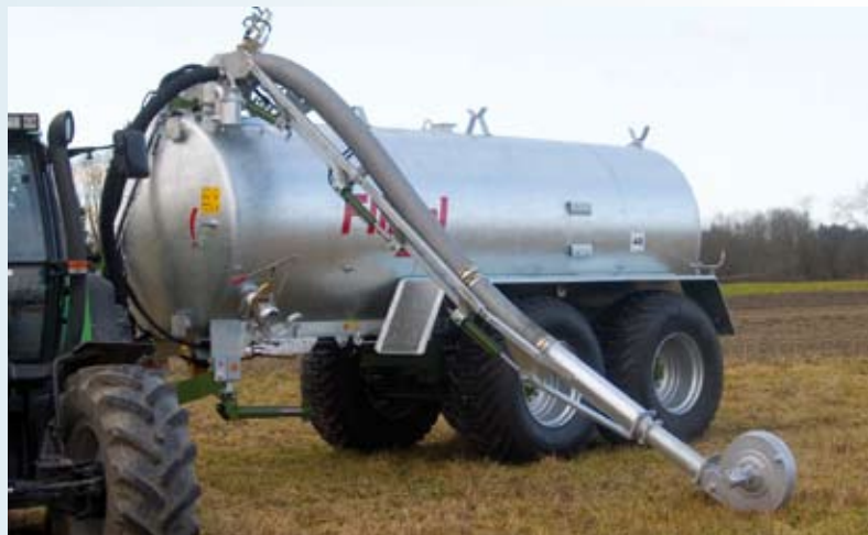
Äußerst flexibler Saugausleger für das Ansaugen von Gülle
