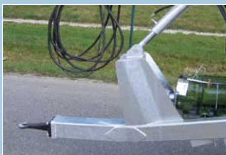
Feuerverzinkte Zugeinrichtung mit Fass-Kippzylinder
