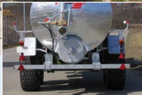
40 km/h Ausführung mit Kotflügel und Unterfahrschutz.
