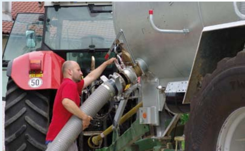
Einfaches andocken durch Schnellkuppelsystem
