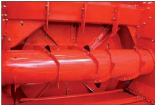
Hydraulicky ovládaný dávkovací válec
