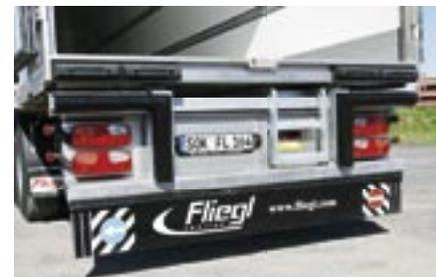
Der Unterfahrerschutz ist geschlossen und mit ausziehbarem Auftritt ausgestattet.
