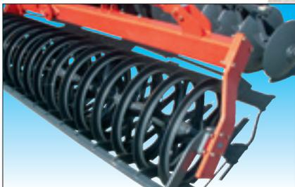
T-Ring-Walze Durchmesser 600 mm - 105 kg/m
