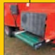
Hydraulischer Seitenversatz für das PVC-Querförderband nach rechts oder links
