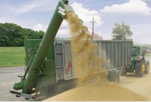
Überladeschnecken für die Getreidernte mit einer Überladeleistung von bis zu 350t/Std.
