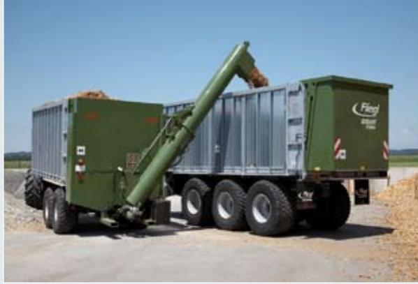
Überladeschnecke mit Fräswalzen für Silage, Hackschnitzel, Hühner trockenkot u.s.w. Überladeleistung bis zu 10 m<sup>3</sup> min.
