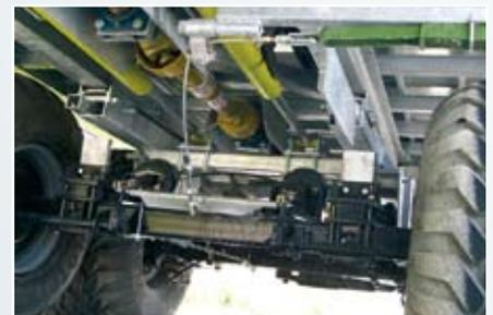
Bessere Anpassung der Stützlast durch hydraulische Achsverschiebung – manuell und automatisch steuerbar.
