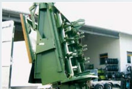
Mit einem Stapler ist das Streuwerk innerhalb von 10 Minuten einfach abmontiert.
