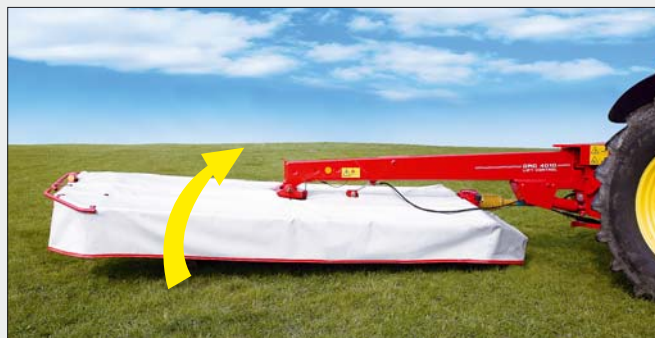
3 Das Mähwerk wird über das Hindernis ausgehoben
