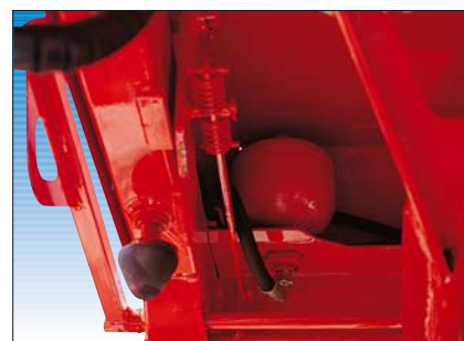
Hydropneumatischer Druckspeicher: effizientes Entlastungssystem und Non-Stop-Anfahrsicherung
