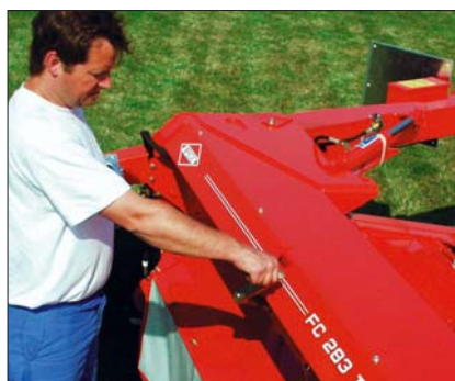
Zentrale Einstellung des Auflagedrucks
