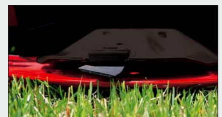
Flaches Mähbalkenprofil: kein Ansammeln von Erde und äußerst leichtzügig
