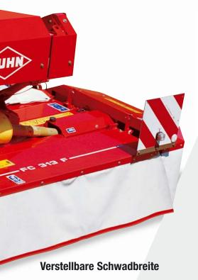
Das Futter kann je nach Wunsch in schmalen oder breiten Schwaden abgelegt werden. Dafür müssen nur die Schwadformer entsprechend ausgerichtet werden. Durch den Anbau einer Breitstreuvorrichtung (Sonderausrüstung) kann das Futter auf der gesamten Breite abgelegt werden.
