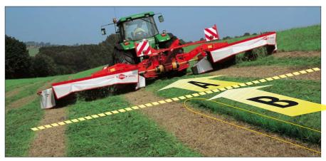
A: Mit Seitenversatz kommt es zu keinen ungemähten Futterstreifen. B: Ohne Seitenversatz sind trotz der großen Überlappung zwischen der vorderen und den hinteren Mäheinheiten ungemähte Futterstreifen erkennbar.
