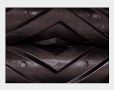
FC 813 R: Quetschwalzen mit Spezial-Rippenprofil
