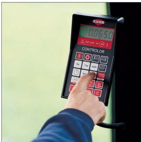
Auf Wunsch kann die MAXIMA mit dem Saatüberwachungs-Computer CONTROLOR ausgerüstet werden.
