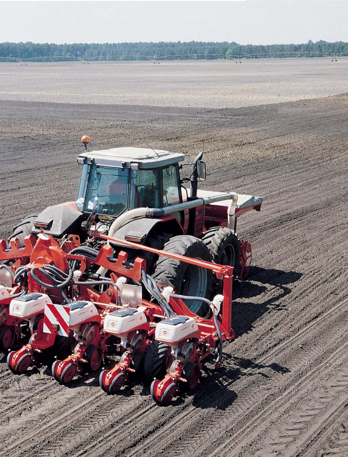
MAXIMA IN 8-REIHIGER, KLAPPBARER AUSFÜHRUNG MIT FRONTTANK TF 702.
