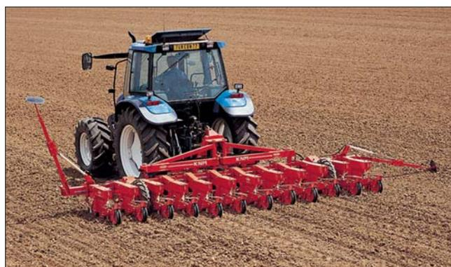
Mechanische Sämaschinen KNM für Zuckerrübenpillen. In Deutschland nicht verfügbar.
