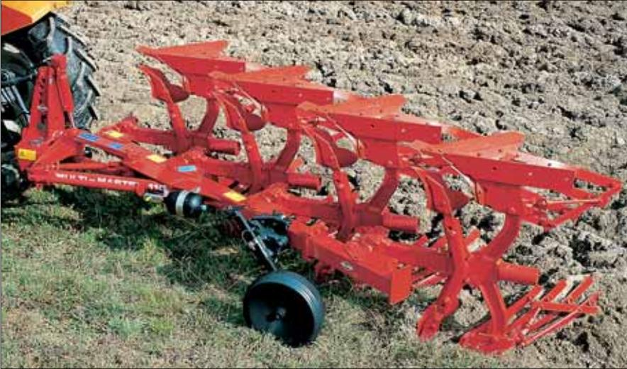
Durch zahlreiche Anbringungsmöglichkeiten am Rahmen kann die Stützradposition verändert und ein seitlicher Überstand vermieden werden.
