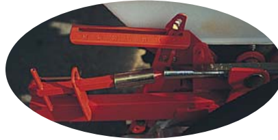
Die Einstellung des Abstreifers gegen Doppelbelegung
