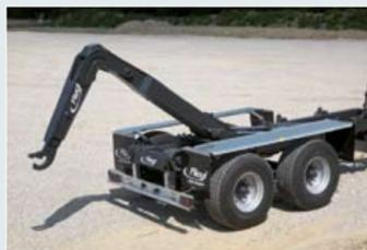
Tandem HKL18 mit Knickarm / Hubkraft 18 Tonnen
