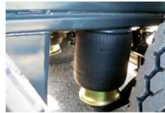
Optional: Luftfederung mit automatischer Kippabsenkung
