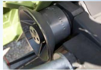
Große Stahlguss-Ablaufrollen (ø 310mm) mit großer Zentrierschräge – erleichtern das Aufziehen der Container in besonderer Weise.
