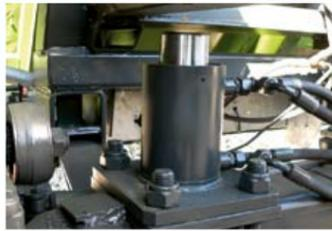
Optional: Hydraulische Abstützung auf die Achse
