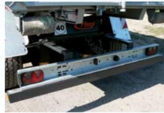
Optional: Ausziehbarer Unterfahrerschutz für größere Containerlängen
