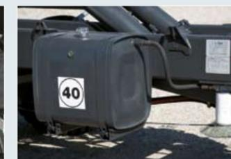
Bordhydraulik 60 Liter (optional 90 L) angetrieben durch Zapfwellenantrieb mit Hydraulikpumpe und Ölbehälter
