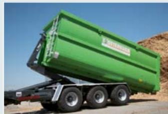
Tridem HKL29 mit Teleskoparm / Hubkraft 26 Tonnen
