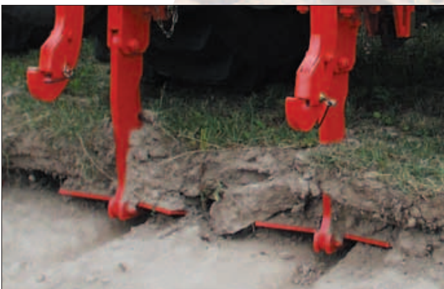
Bodenlockerung auf der gesamten Arbeitsbreite
