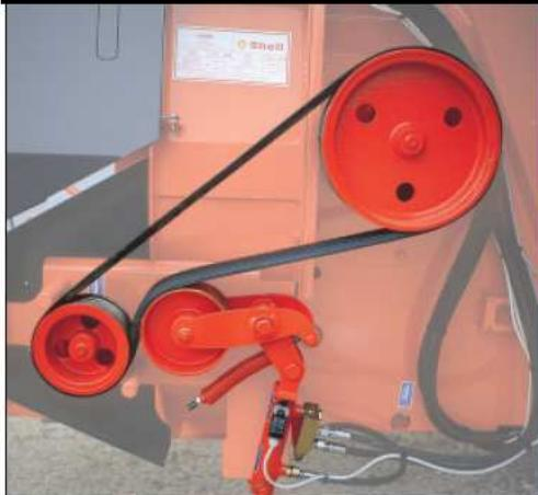
**POLYDRIVE - systém, který pomocí hydrauliky zapojí mechanický řemenový převod - spolehlivě a bezpečně**
