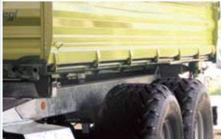
Zentralverriegelung seitlich, ab EDK 60 serienmäßig. Ab 4.500 mm Brückenlänge 6-fach verriegelt, durchgehendes nicht eingeschnittenes Brückenprofil.
