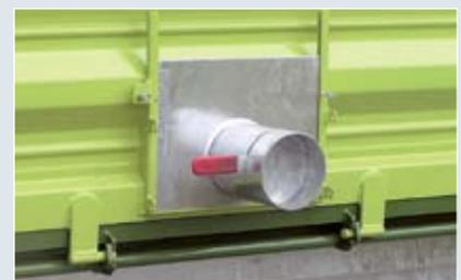
Rohrauslauf mit Auslaufstützen
