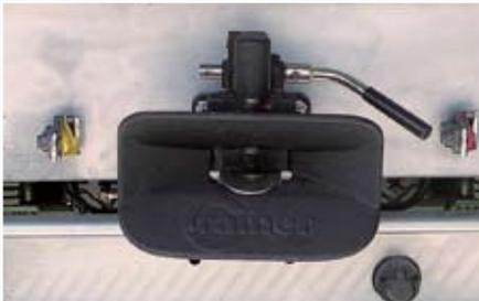
Automatische Anhängerkupplung mit Hydraulik- und Bremsanschluß für zweite Anhänger.
