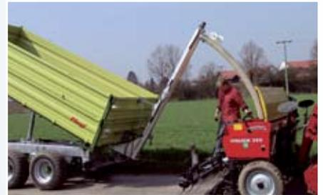
Überladeschnecke Ø 168 mm, Länge 3.000 mm, verzinkt oder aus Edelstahl, leicht zu montieren, mit Seilwinde verstellbar, Laufräder zum Transport.
