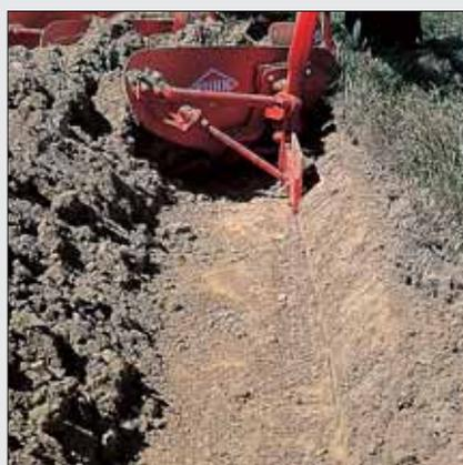
Das ergibt eine leichtzügigere und dadurch schnellere Pflugarbeit. Einsatz eines zusätzlichen Rautenkörpers möglich.
